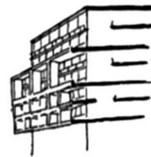
L'unité d'Habitation de Marseille et le principe du brise-soleil
